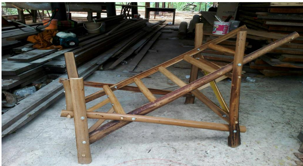
ภาพที่ ๔.๘ การขึ้นโครงข้างเก้าอี้
